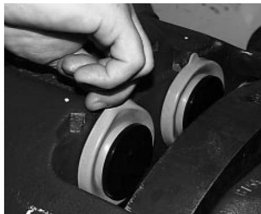
**F.**重新裝入碟片固定夾並且以33~40Nm的鎖緊力將螺帽鎖緊。
